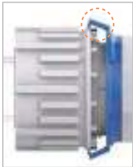
너트 체결 상태 불량 (미체결 상태) Nut not tightened (Not assembled)
